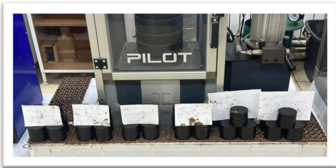
Рис. 2. Формованные образцы, готовые для определения физико-механических свойств.
