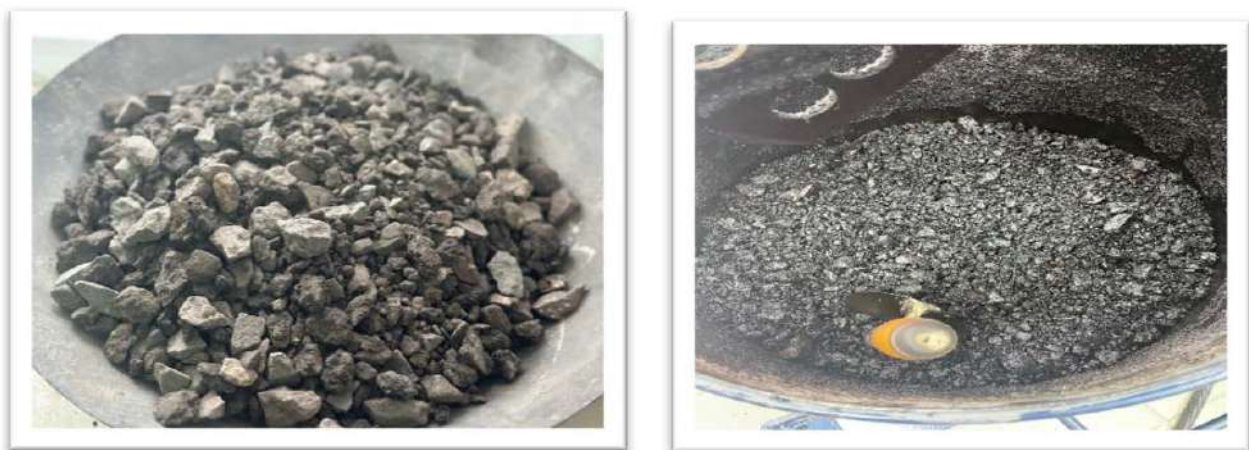
Рис. 1. Фрезерованная асфальтобетонная смесь до и после добавления добавки.
